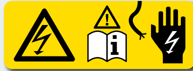
Warnhinweisschild Hochvolt-Komponente, Ausführung 2
